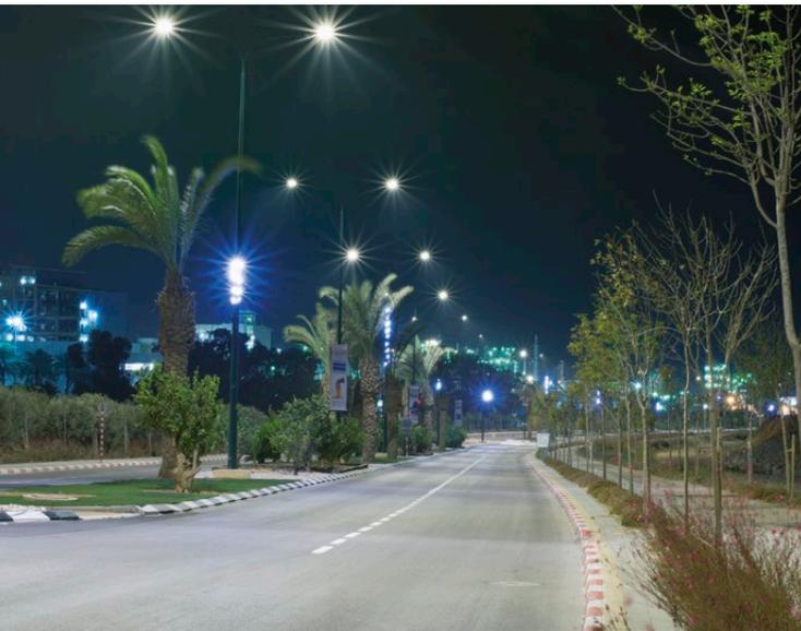
**Minuit virtuel sous-code -30 :** les luminaires sont équipés d'un gradateur à 4 niveaux de puissance qui se basent sur le calcul du minuit virtuel.
