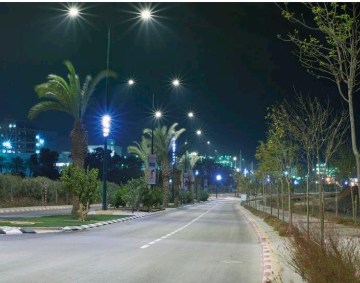
**Medianoche virtual subcódigo -30:** las luminarias tienen un dispositivo para la regulación en **4 pasos** de potencia basados en el cálculo de la medianoche virtual.
