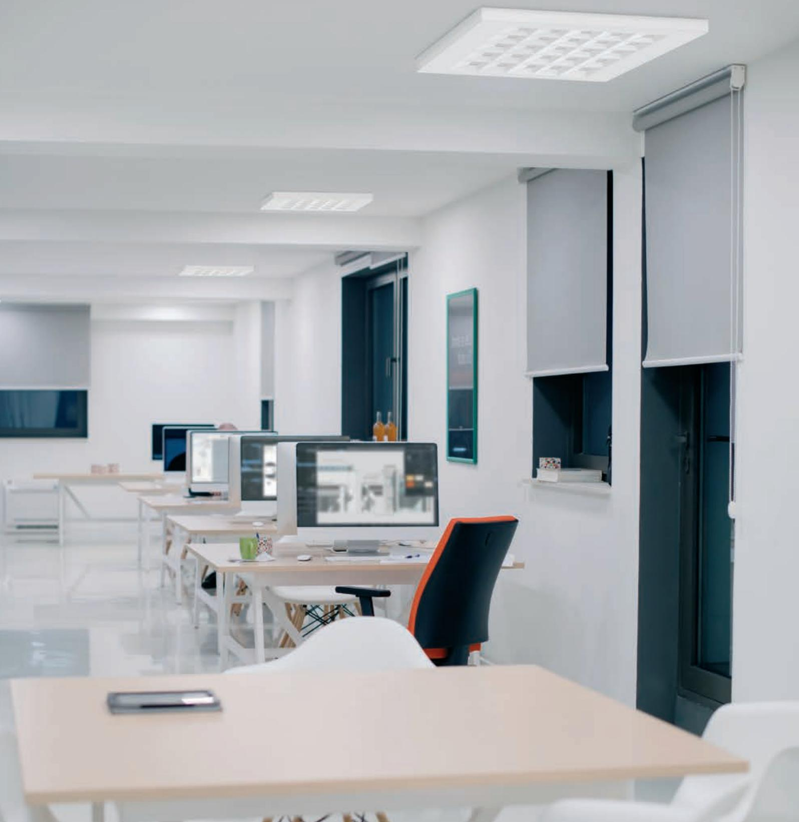
Le plafonnier Comfortsquare comporte, en version standard, une cellule de présence/lumineuse pour son allumage ou son extinction en cas de présence détectée, en fonction du niveau de luminosité dans la pièce. À l'allumage, le plafonnier repart du cycle prédéfini.
