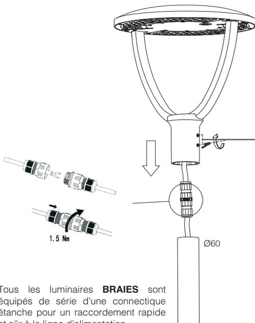
Tous les luminaires **BRAIES** sont équipés de série d'une connectique étanche pour un raccordement rapide et sûr à la ligne d'alimentation.
