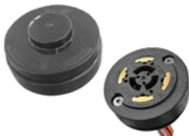
La presa **Zhaga Socket** consiste in un'interfaccia standardizzata tra il connettore femmina sull'apparecchio di illuminazione e i componenti di base e copertura che insieme formano l'alloggiamento del modulo di controllo. Le guarnizioni integrate, con basso attrito e accoppiabili, proteggono sia l'apparecchio che il modulo. Materiali resistenti ai raggi UV e resistenza ai forti impatti completano le caratteristiche di questo robusto connettore.
