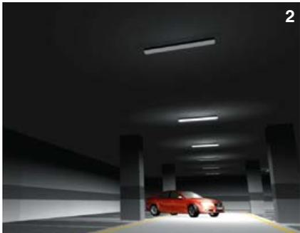
2 Quando viene rilevato un movimento, il sensore accenderà la luce al 100% di luminosità.
