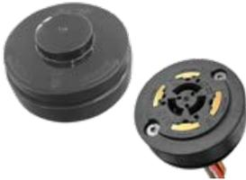
La clavija **Zhaga Socket** consiste en una interfaz estandarizada entre el conector hembra de la luminaria y los componentes de la base y la cubierta que juntos forman el alojamiento del módulo de control. Las juntas integradas, con baja fricción y acopladas, protegen tanto la luminaria como el módulo. Materiales resistentes a los rayos UV y resistencia a fuertes impactos completan las características de este robusto conector.
