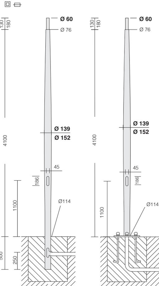
Dimensions du massif en ciment (en fonction du terrain)
