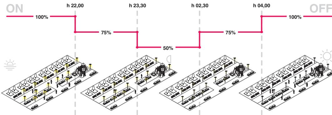
Par exemple, dans les heures centrales de la nuit, dans les zones où le trafic automobile et piétonnier baisse considérablement, **la diminution du flux lumineux maintient l'éclairage à un niveau de sécurité**, en évitant les gaspillages. Multiplié par les dizaines ou centaines de points lumineux, **les gains sont énormes.**
