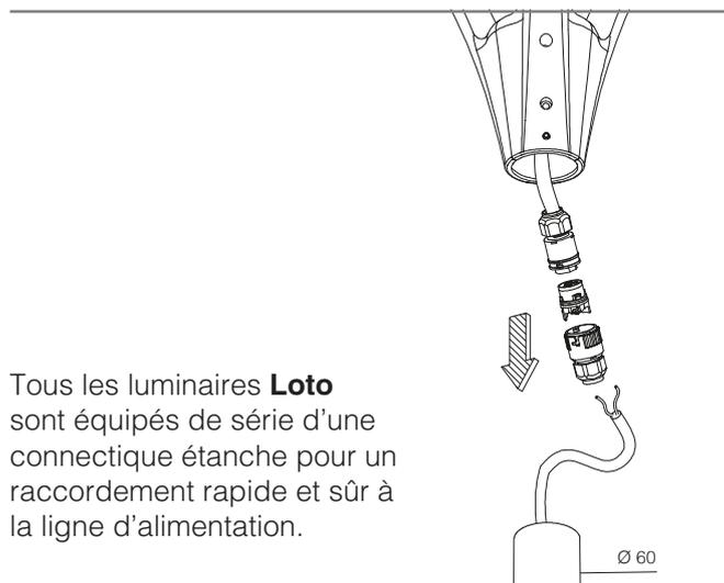
Tous les luminaires **Loto** sont équipés de série d'une connectique étanche pour un raccordement rapide et sûr à la ligne d'alimentation.
